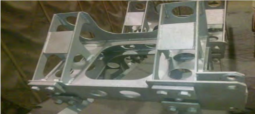
Pieza tras una limpieza grado SA2½ mediante granallado.
