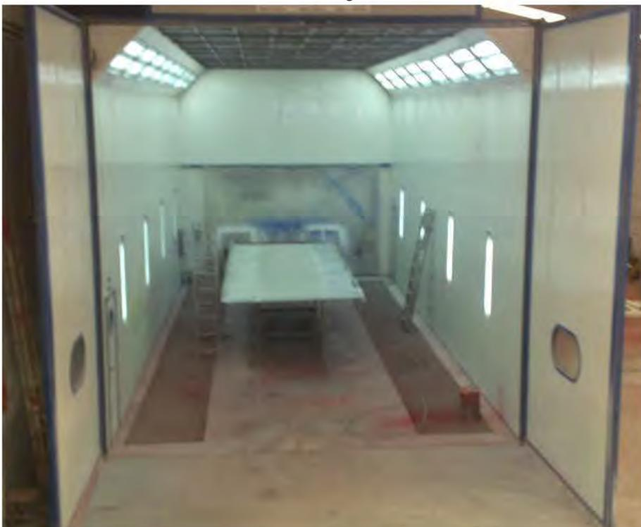
Cabina de Pintura. 13 metros de longitud x 5.5 metros de ancho x 5.5 metros de alto.
