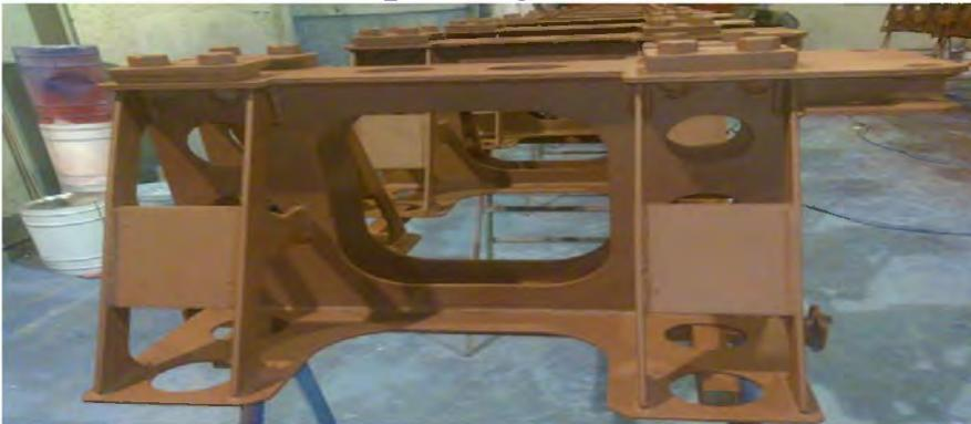
Aplicación de imprimación epoxi anticorrosiva.
