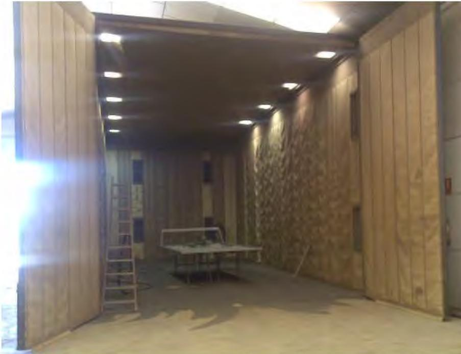
Cabina de Granallado. 13 metros de longitud x 5.5 metros de ancho x 5.5 metros de alto.
