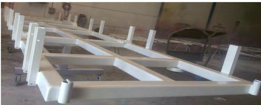
Una vez aplicada la imprimación epoxi como protección anticorrosiva.
