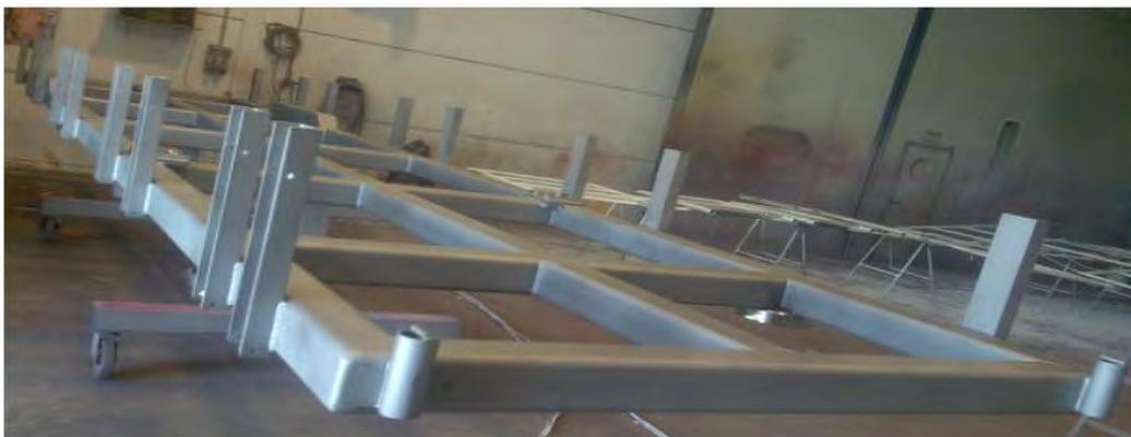
Estructura granallada hasta alcanzar un grado SA 2½ de limpieza.
